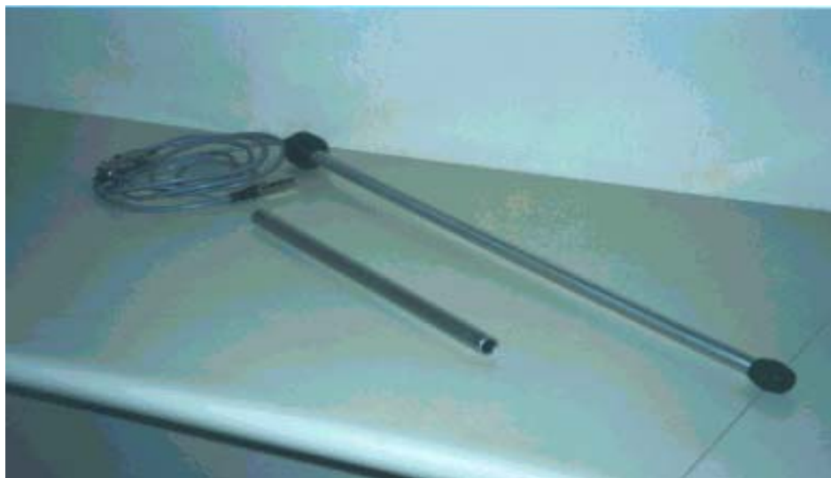
Figura 10. Tubo de ondas e tubo de calibração
